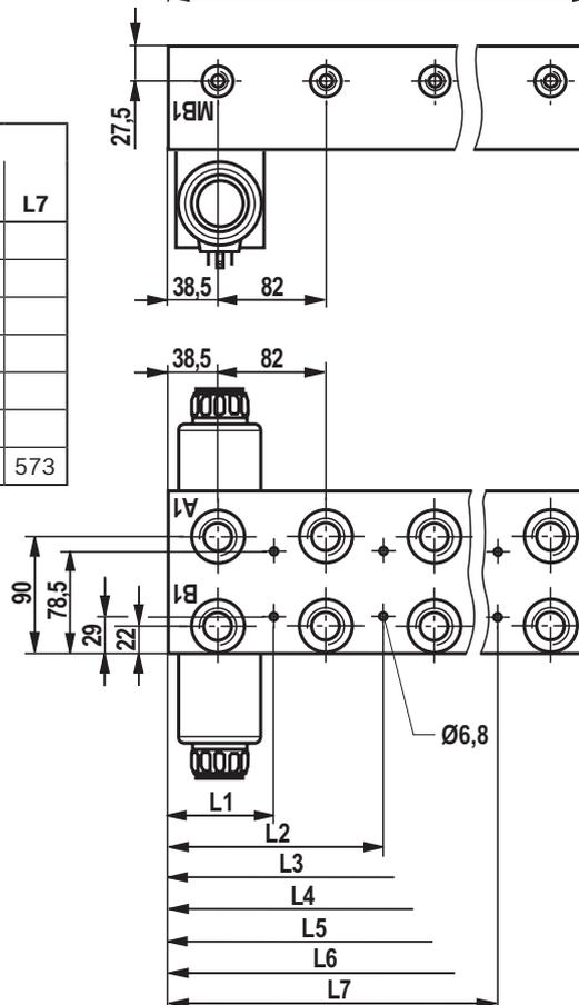
**Abmessungen: Reihenplatte 1HSR10-15/01C**
