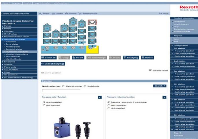
Die Auswahl der einzelnen Komponenten erfolgt dabei entweder nach Typenschlüssel oder Materialnummer, über eine schaltplanorientierte Konfiguration oder über eine „Schritt-für-Schritt“ Selektion der einzelnen funktionalen Eigenschaften des Ventils oder der Zwischenplatte.
