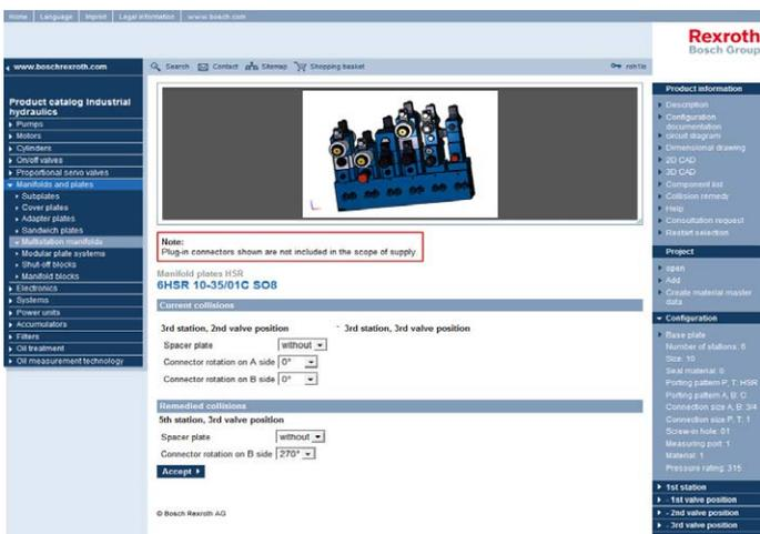
Nach vollständiger Konfiguration bietet eine Kollisionsprüfung verschiedene Möglichkeiten, eine bestehende Kollision zu beheben.
