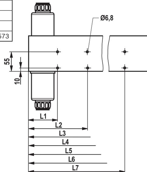
**Abmessungen:** Reihenplatte 2...8HSR10-15/01D (ohne Messanschlüsse MA, MB)
