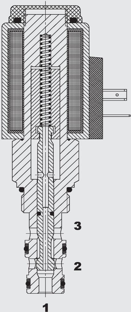
Bei nicht bestromter Magnetspule kann das Ventil von Anschluss 2 nach 3 durchströmt werden, während Anschluss 1 geschlossen ist.
