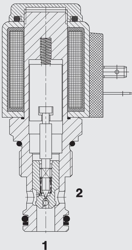
Bei nicht bestromter Magnetspule ist das Ventil von Anschluss 2 nach 1 gesperrt. Von Anschluss 1 nach 2 kann es frei durchströmt werden.
