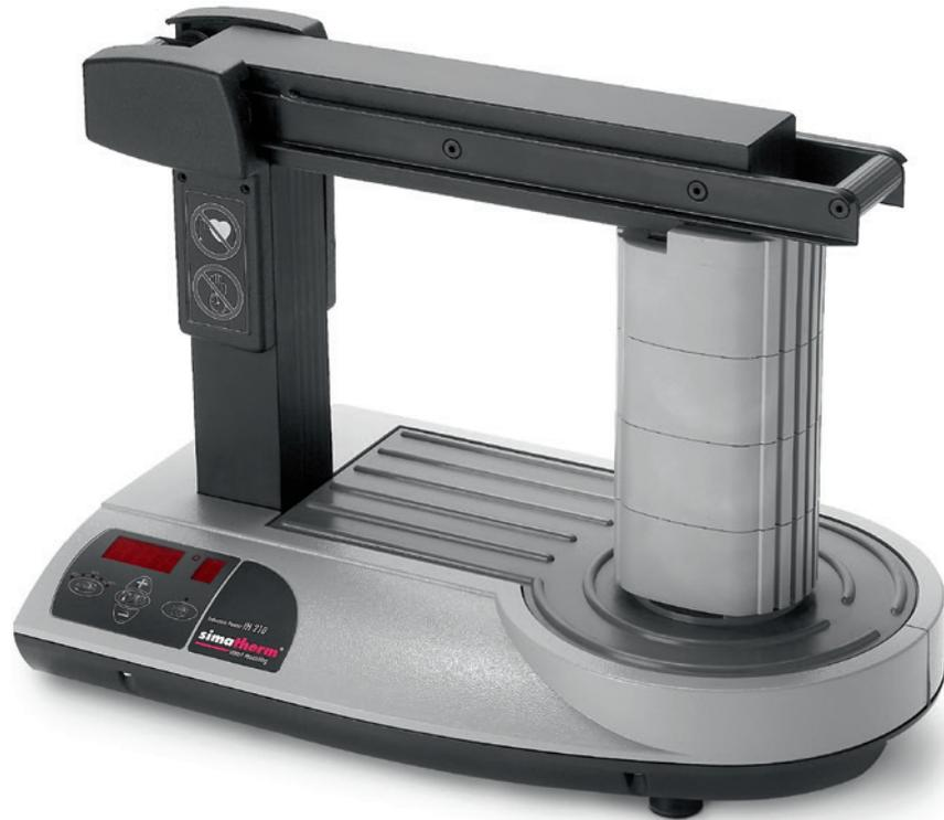
Das grosse simatherm Induktions-Anwärmgerät für Wälzlager und andere ringförmige Metallteile bis 640 mm Bohrung und 250 x 250 mm Querschnitt. Mit der Zeit- und Temperaturautomatik lassen sich Wälzlager auf die von Herstellern vorgeschriebenen 110°C bzw. andere ringförmige Metallteilen bis 400°C aufwärmen.
