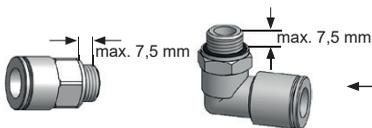
← Anschlussstücke (6 Stück) zum Anschließen der Schmierstoffleitungen an geöffnete Auslässe,
