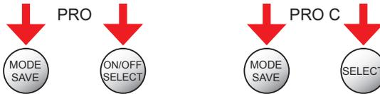
Bild 15 Zur manuellen Initialisierung beide Tasten des Schmierstoffgebers gleichzeitig gedrückt halten.
