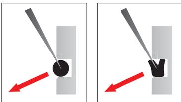
**Stech-Werkzeug, entfernt Dichtungen und O-Ringe aus normal oder schwer zugänglichen Einbauräumen. Die Dichtung kann dadurch nicht mehr wiederverwendet werden**
