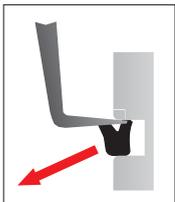
**Winkelhebel-Werkzeug, entfernt Dichtungen und O-Ringe durch Hebelwirkung aus normal oder schwer zugänglichen Einbauräumen.**
