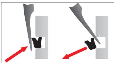
**Flach-Werkzeug, entfernt oder positioniert Dichtungen und O-Ringe, die leicht zugänglich sind. Kombinierbar mit anderen Werkzeugen.**
