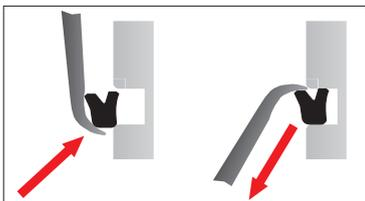
**Abziehhebel-Werkzeug, entfernt Dichtungen und O-Ringe oder positioniert sie.**
