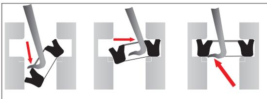
**Druck- und Zugwerkzeug, oder "Allzweckwerkzeug"** Durch seine besondere Form kann es zum einhaken, positionieren schieben oder ziehen von Dichtungen und O-Ringe verwendet werden. Durch drücken mit der Rückseite können diese in Ihrer Nut festgedrückt werden, ohne diese zu beschädigen.
