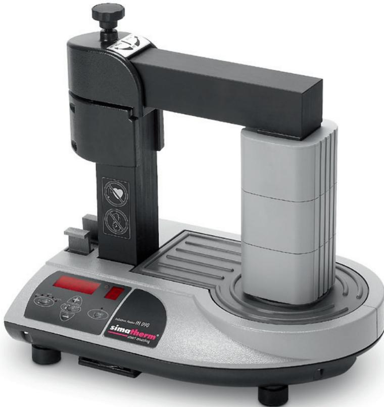
Das mittelgrosse simatherm Induktions-Anwärmgerät für Wälzlager und andere ringförmige Metallteile bis 400 mm Bohrung und 145 x 205 mm Querschnitt. Mit der Zeit- und Temperaturautomatik lassen sich Wälzlager auf die von Herstellern vorgeschriebenen 110°C bzw. andere ringförmige Metallteile bis 400°C aufwärmen.
