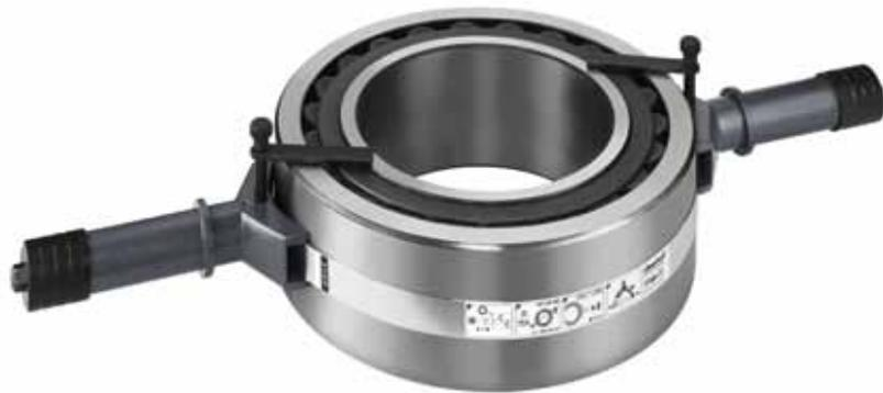
Das Bearing Handling Tool eignet sich ideal für das fachmännische und sichere Anheben von grossen und schweren Lagern. Mit dem BHT vermeidet man das Unfallrisiko und die Gefahr einer Beschädigung des Lagers. Das BHT umschliesst den Aussenring des Lagers mit einem Stahlband. Zwei gegenüberliegende Griffe und zwei Tragriemen erlauben die einfache Handhabung mit einem Hebekran. Die Bohrung bleibt frei, so kann das Lager einfach auf eine Welle geschoben werden.
