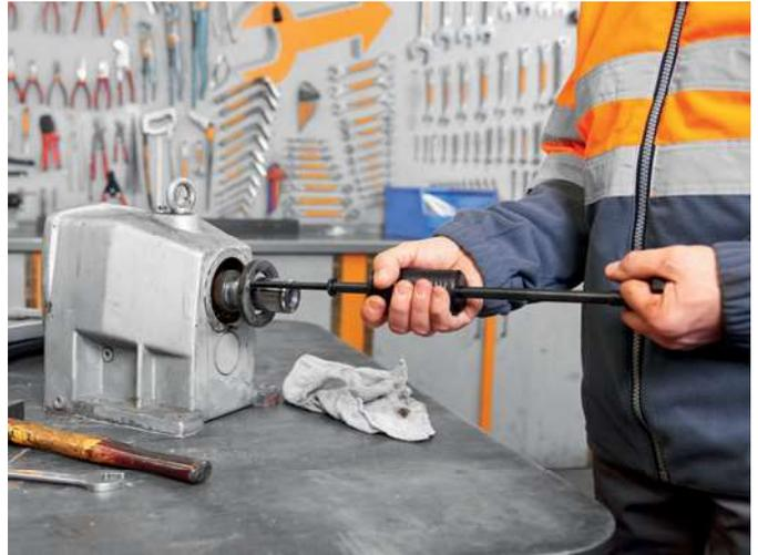
Gewusst wie: Ausbau einer Wellendichtung an einem Getriebe mit dem simatool Seal Puller SP 50.
