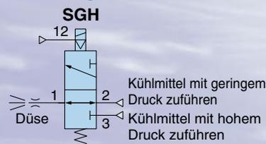
Kühlmittel kann unter verschiedenen Drücken zugeführt werden.
