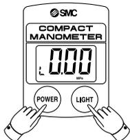
Durch Aktivieren des Verriegelungsmodus wird die automatische Abschaltung deaktiviert.
