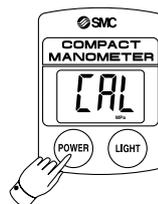
Der bei Atmosphärendruck angezeigte Nullpunkt lässt sich automatisch einstellen. So können Anzeigeabweichungen bei verändertem Atmosphärendruck vermieden werden.
