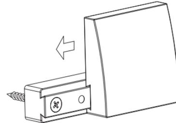
Abbildung 4: Aufsetzen der Fenstersicherung
