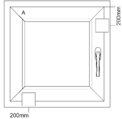
Abbildung 3: Position der Zusatzsicherung
