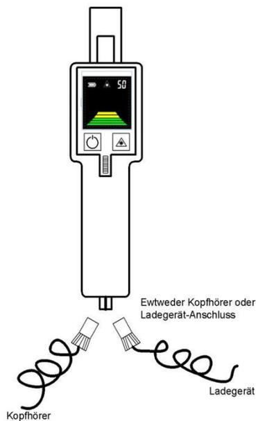
Bild B: Anschluss Kopfhörer- und Ladegerät
