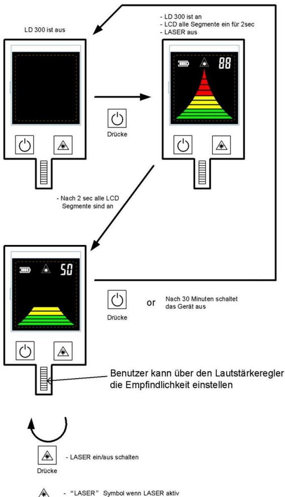
Bild A: LS 100 Bediendiagramm
