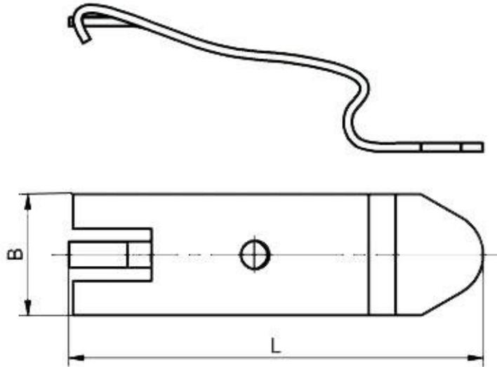
**Befestigungssatz (Schiene) für Grundejektoren**
