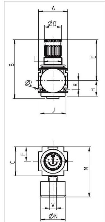
**Präzisionsdruckregler inkl. Manometer**
