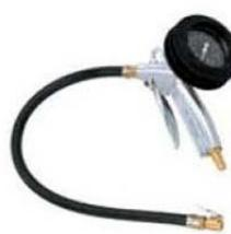
Handreifenfüllmesser mit Messbereich 0-10 bar für den Gebrauch an öffentlichen Tankstellen o.ä. sind von der Eichbehörde geeicht und entsprechend gekennzeichnet. Die Gültigkeit der Erstcalibration beträgt 2 Jahre. Nach Ablauf der Eichfrist muss das Gerät nachgeeicht werden.
