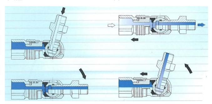
Voller Durchgang ohne Umlenkung der Strömung
