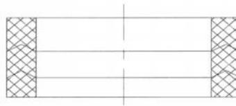
Installieren Sie die Stopfbüchse vom Stamm entsprechend der Richtung in obiger Zeichnung;
