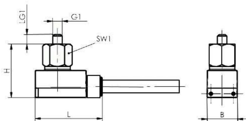
**Vakuumsensor, analoger Sensor**
