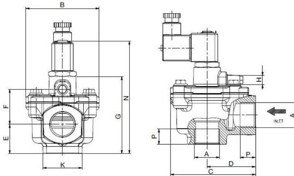
**Impulsmembranventil stromlos geschlossen, 230 V, 50 - 60 Hz, interne Vorsteuerung**
