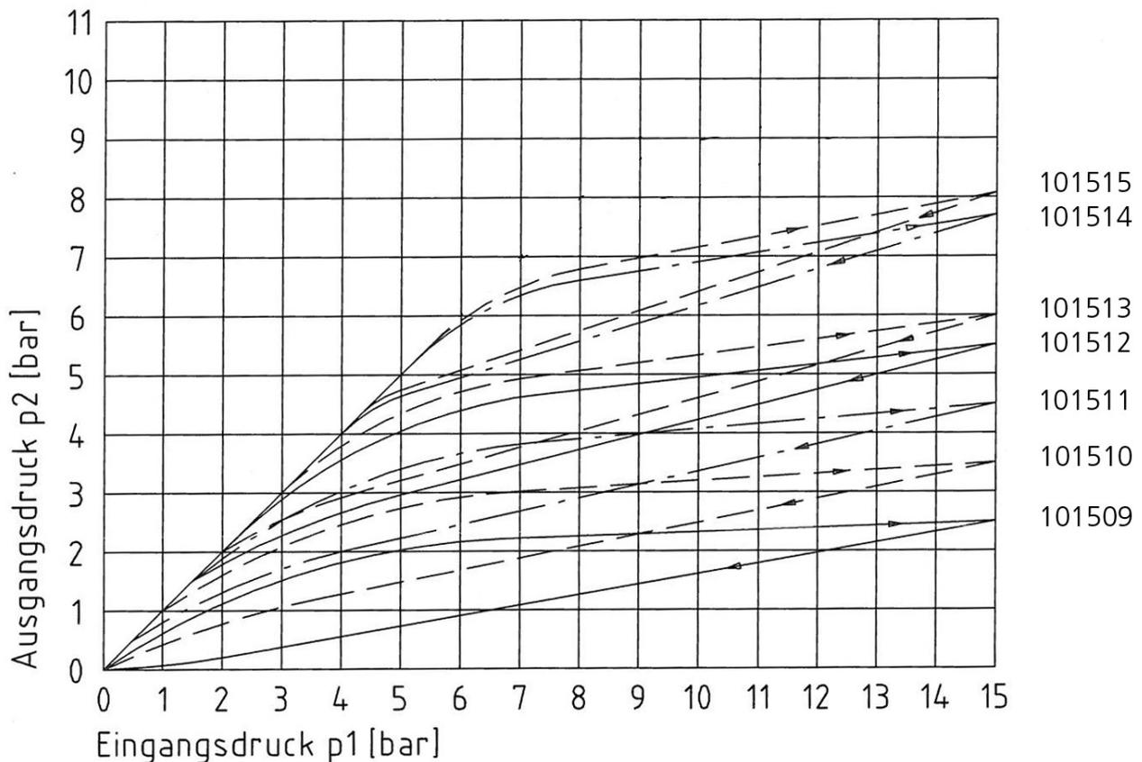
max. Durchfluss bei einem Eingangsdruck  $p_1 = 15$  bar:
