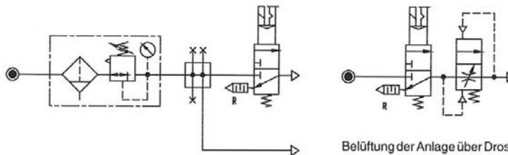
Druckluftanlagen oder Teile von Anlagen können ein- oder abgeschaltet und entlüftet werden.
