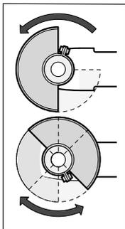
Coloque a tampa de proteção (10) na gola do veio. Ajuste a posição da tampa de proteção (10) de acordo com os requisitos da operação. Fixe a tampa de proteção (10) apertando o parafuso de fixação (9) com uma chave sextavada interno (4).
