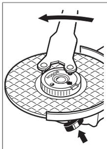
W kołnierzu mocującym (13) na podtoczeniu znajduje się uszczelka (o-ring). **Jeżeli brakuje tej uszczelki lub jest ona uszkodzona, kołnierz mocujący (13) należy koniecznie wymienić przed przystąpieniem do dalszej eksploatacji narzędzia.**
