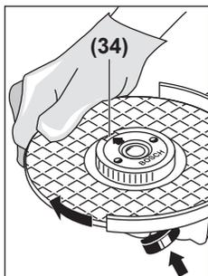
Druk op de asblokkeerknop (2) om de slijpas vast te zetten. Om de snelspanmoer vast te draaien, draait u de slijpschijf krachtig met de klok mee (naar rechts).
