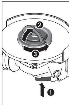
Propisno pritegnutu i neoštećenu navrtku sa brzim zatezanjem (19) možete ručno da otpustite. Podignite luk navrtke za brzo zatezanje okrenite snažno suprotno od kretanja kazaljke na satu. Nikada nemojte da odvrćete navrtku sa brzim zatezanjem pomoću alata, već koristite ključ sa dva otvora.
