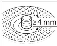
Tras el montaje de la brida de alojamiento y del disco lijador/tronzador, la longitud de la rosca del husillo amolador debe ascender a como mínimo 4 mm.
