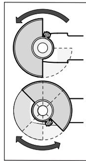
Nasadte ochranný kryt (10) na krk vřetena. Nastavte polohu ochranného krytu (10) podle požadavků příslušné práce. Zaaretujte ochranný kryt (10) utažením zajišťovacího šroubu (9) klíčem na vnitřní šestihran (4).
