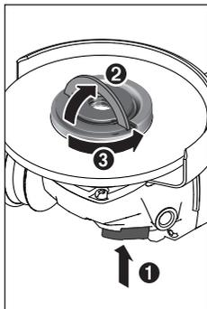
Actionnez la touche de blocage (2) pour bloquer la broche. Pour serrer l'écrou de serrage rapide (19), rabattez l'étrier de l'écrou vers le haut et tournez fermement l'écrou de serrage rapide dans le sens horaire. Rabattez ensuite l'étrier vers le bas pour bloquer l'écrou de serrage rapide. **Un serrage au niveau de la périphérie du disque n'est pas suffisant.**
