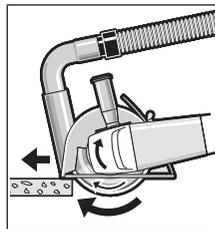
Zapnite elektrické náradie a priložte ho prednou časťou vodiacich saní na obrobok. Posúvajte elektrické náradie s miernym posúvaním, prispôbeným opracovávanému materiálu.
