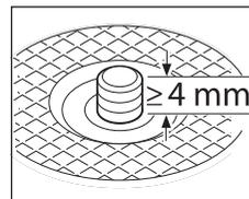
Pressione a tecla de bloqueio do veio (2), para bloquear o veio de retificação. Para apertar a porca de aperto rápido (19), vire o aro da porca de aperto rápido para cima e rode a porca de aperto rápido com força para a direita. Depois vire o aro para baixo para fixar a porca de aperto rápido. **Não é possível apertar no rebordo do disco.**
