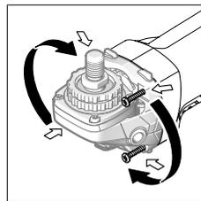
Možete okretati glavu prenosioca u koracima od 90°. Na taj način možete prekidač za uključivanje/isključivanje za posebne slučajeve u radu dovesti u povoljniju poziciju za držanje ruke, na primer za levoruke.
