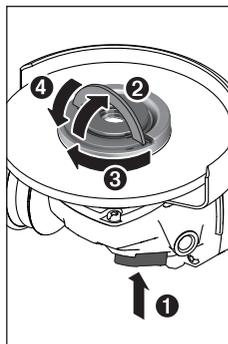
Presione la tecla de bloqueo del husillo (2), para inmovilizar el husillo amolador. Para apretar la tuerca de fijación rápida (19), levante el estribo de la tuerca de fijación rápida y gire vigorosamente la tuerca de fijación rápida en el sentido de las agujas del reloj. Baje luego el estribo para la fijación de la tuerca de fijación rápida. **Un apriete en el borde del disco no es suficiente.**
