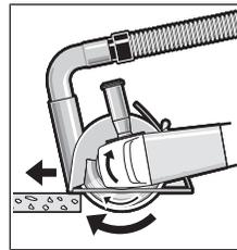
Włączyc elektronarzędzie i oprzeć je przednią częścią prowadnicy saneczkowej o obrabiany element. Pracować z równomiernym posuwem, dostosowanym do właściwości obrabianego materiału.
