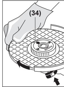
Натисніть на фіксор шпінделя (2), щоб зафіксувати шліфувальний шпіндель. Для затягнення швидкозатискної гайки із силою поверніть шліфувальний круг за стрілкою годинника.
