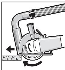
Start el-værktøjet, og sæt det på emnet med den forreste del af føringsslæden. Skub el-værktøjet med et moderat tryk, tilpasset til materialet der skal bearbejdes.
