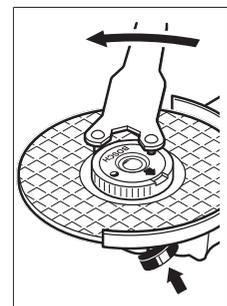
En korrekt fastgjort og intakt lynspændemøtrik kan løsnes ved at dreje roulettringen mod uret med hånden. **Brug aldrig en tang til at løsne en fastsiddende lynspændemøtrik, men anvendt i stedet spændenøglen.** Sæt spændenøglen på som vist på billedet.
