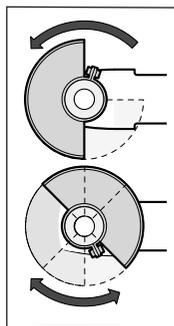
Applicare la cuffia di protezione (10) sul collare dell'alberino. Adattare la posizione della cuffia di protezione (10) in base alla lavorazione da eseguire. Bloccare la cuffia di protezione (10) serrando la vite di fissaggio (9) con la chiave a brugola (4).
