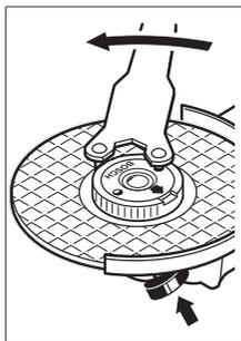
Propisno pričvršćenu, neoštećenu brzosteznu navrtku možete da odvrnete tako što ćete rukom okretati izreckani prsten u smeru suprotnom od kretanja kazaljke na satu. **Nikada nemojte da odvrćete brzosteznu navrtku kleštima, već koristite ključ sa dva otvora.** Postavite ključ sa dva otvora kao što je prikazano na slici.
