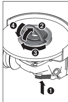
Drücken Sie die Spindel-Arretiertaste (2), um die Schleifspindel festzustellen. Um die Schnellspannmutter (19) festzuziehen, klappen Sie den Bügel der Schnellspannmutter hoch und drehen Sie die Schnellspannmutter kräftig im Uhrzeigersinn. Klappen Sie danach den Bügel zum Fixieren der Schnellspannmutter herunter. **Ein Anziehen am Scheibenrand ist nicht ausreichend.**
