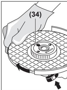
Nacisnąć przycisk blokady wrzeciona (2), aby unieruchomić wrzeciono szlifierki. Aby dokręcić szybkozaciskową nakrętkę mocującą, należy energicznym ruchem obrócić tarczę szlifierską w kierunku zgodnym z ruchem wskazówek zegara. **Zbyt mocno dokręconej szybkozaciskowej nakrętki mocującej nie wolno odkręcać za pomocą kombinerek, lecz należy użyć klucza widelkowego.** Przyłożyć klucz
