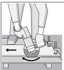
Az elektromos kéziszerszámot mindig a forgásirányával ellentétes irányban kell vezetni. Ellenkező esetben a készülék **irányíthatatlanul** kiugorhat a vágásból. Profilok és négyzetleges csövek darabolásánál a legcélszerűbb a legkisebb keresztmetszetenél kezdeni a darabolást.
