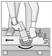
Toujours travailler en opposition (pas en avalant). Le disque risque sinon de sortir de la ligne de coupe **de façon incontrôlée**. Lors du troncçonnage de profilés et de tubes à section carrée, débutez au niveau de la plus petite section.
