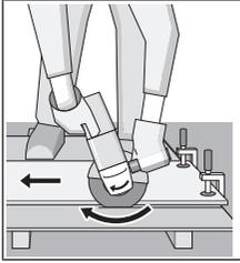
Elektrikli el aleti her zaman ters dönüşte kullanılmalıdır. Aksi takdirde aletin **kontrol dışında** kesim yerinden dışarı çıkma tehlikesi vardır. Profiller ve dört köşe borular kesilirken en küçük kesiti kullanın.
