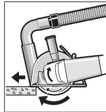
Accendere l'elettrotensile ed applicarlo con la parte anteriore della slitta di guida sul pezzo in lavorazione. Spingere l'elettrotensile verso il materiale da lavorare, con un avanzamento moderato, in base al tipo di materiale.
