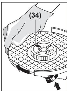
Trykk på spindellåseknappen (2) for å låse slipespindelen. For å låse hurtigspennmutteren dreier du slipeskiven hardt med urviseren.
