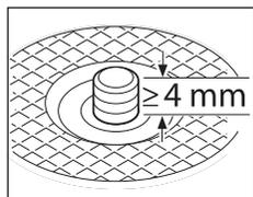
Tugiäärüku ja lihv-/löikeketta paigaldamise järel peab vaba spindlikeerme pikkus olema vähemalt 4 mm.
