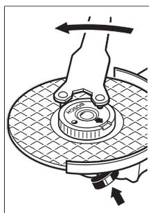
En hurtigspennmutter som er festet riktig og er uskadet, kan løses ved at du dreier den riflede ringen for hånd mot urviseren. **En hurtigspennmutter som sitter fast, må aldri løses med en tang. Bruk tohullsnøkkelen.** Sett tohullsnøkkelen som vist på bildet.
