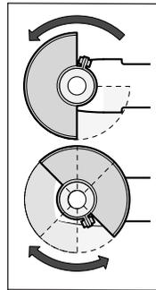
Nasadte ochranný kryt (10) na krk vretena. Nastavte polohu ochranného krytu (10) podľa požiadaviek príslušnej práce. Ochranný kryt (10) zaaretujte utiahnutím zaistovacej skrutky (9) pomocou kľúča s vnútorným šesťhranom (4).
