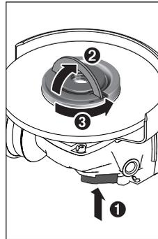
Een correct bevestigde, onbeschadigde snelspanmoer (19) kunt u met de hand losdraaien. Klap hiervoor de beugel van de snelspanmoer omhoog en draai de snelspanmoer stevig naar links. Draai een vastzittende snelspanmoer nooit met een gereedschap los, maar gebruik een pensleutel.
