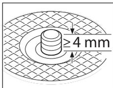
Efter montering af holdeflangen og slibe-/skæreskiven skal den fri slibespindelgevindlængde være **mindst 4 mm**.
