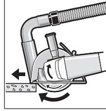
Elektrikli el aletini açın ve kılavuz kızakın ön parçasını iş parçası üzerine yerleştirin. Elektrikli el aletini hafif bir bastırma kuvveti ve işlediğiniz malzemeye uygun bir tempo ile itin.
