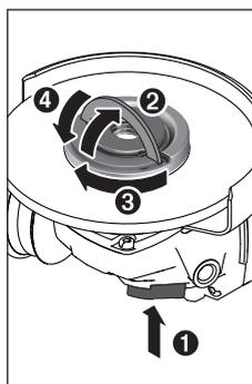
Pritisnite taster za aretiranje vretena (2) kako biste fiksirali brusno vreteno. Da biste pričvrstili navrtku za brzo zatezanje (19), podignite luk navrtke za brzo zatezanje i snažno je okrenite u pravcu kretanja kazaljke na satu. Podignite zatim luk kako biste fiksirali navrtku za brzo zatezanje. **Nije dovoljno povlačenje za ivicu ploče.**
