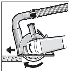
Porniți scula electrică și așezați-o cu partea frontală a saniei de ghidare, pe piesa de prelucrat. Împingeți scula electrică exercitând un avans moderat, adaptat la materialul de prelucrat. La tăierea materialelor foarte dure, precum
