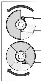
Поставете предпазния кожух (10) върху шийката на вала. Регулирайте позицията на предпазния кожух (10) съобразно конкретните работни условия. Фиксирайте предпазния кожух (10) чрез затягане на финта (9) с комбинирания ключ (4).
