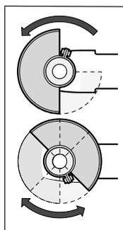
Установите защитный кожух (10) на шейку шпинделя. Отрегулируйте положение защитного кожуха (10) в соответствии с требованиями рабочего процесса. Зафиксируйте защитный кожух (10), затянув крепежный винт (9) с помощью ключа-шестигранника (4).
