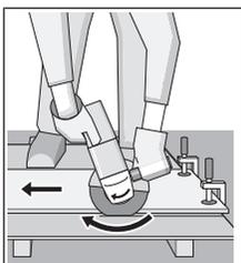
Het elektrische gereedschap moet altijd in tegenloop worden geleid. Anders bestaat het gevaar dat het ongecontroleerd uit de groef wordt gedrukt. Bij het doorslijpen van profielen en vierkantbuizen zet u het beste bij de kleinste doorsnede aan.
