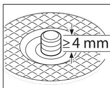
После монтажа опорного фланца и шлифовального/отрезного круга длина свободной резьбы шлифовального шпинделя должна составлять **не менее 4 мм**.
