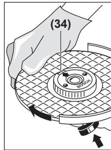
Tryk på spindellåsetasten (2) for at låse slibespindlen. For at spænde lynspændemøtrikken skal du dreje slibeskiven hårdt med uret.
