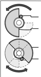
Coloque la cubierta protectora (10) sobre el cuello del husillo. Adapte la posición de la caperuza protectora (10) a las necesidades del paso de trabajo. Bloquee la cubierta protectora (10) apretando el tornillo de sujeción (9) con la llave macho hexagonal (4).
