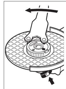
Dacă piulița cu strângere rapidă este nedeteriorată și a fost fixată corespunzător, o puteți slăbi manual, prin rotirea manuală în sens antiorar a inelului zimțat. **Nu slăbiți niciodată cu cleștele o piuliță cu strângere rapidă blocată, ci folosiți cheia pentru șplinturi în acest scop.** Așezați cheia pentru șplinturi conform reprezentării din imagine.
