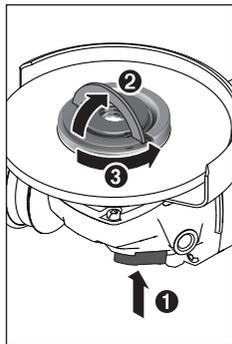
Для фиксирования шлифовального шпинделя нажмите кнопку фиксирования шпинделя (2). Чтобы затянуть быстрозажимную гайку (19), поднимите скобу быстрозажимной гайки вверх и с усилием поворачивайте быстрозажимную гайку по часовой стрелке. Затем опустите скобу быстрозажимной гайки для фиксирования быстрозажимной гайки.
