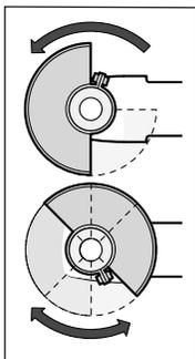
Sätt på skyddskåpan (10) på spindelhalsen. Anpassa skyddskåpan (10) position till arbetsstegets krav. Lås skyddskåpan (10) genom att dra åt låsskruven (9) med insexnyckeln (4).
