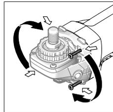
La testa ingranaggi è ruotabile in step da 90°. In questo modo è possibile portare l'interruttore di avvio/arresto in una posizione più comoda in funzione della situazione di lavoro, ad es. per i mancini.
