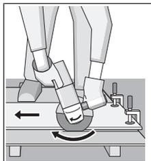
Всегда ведите электроинструмент против направления вращения. В противном случае существует опасность **неконтролируемого** вырывания инструмента из проreзи. При резке профилей или четырехгранных труб начинайте рез на наименьшем поперечном сечении.
