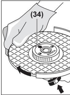
Presione la tecla de bloqueo del husillo (2), para inmovilizar el husillo amolador. Para apretar firmemente la tuerca de fijación rápida, gire el disco abrasivo con fuerza en sentido horario.
