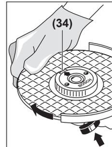
مهره مهر سریع طبق مقررات تعبیه شده و بدون عیب را می توان با چرخاندن رینگ کنگره دار در خلاف جهت عقربه های ساعت با دست باز کرد. مهره مهر سریع سفت شده را هرگز توسط یک آچار شلاقی باز نکنید، بلکه از یک آچار دو سوزنه استفاده نمایید. آچار دوسوزنه را مانند تصویر قرار دهید.
