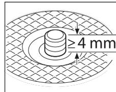
Vauriottoman ja kunnolla kiinnitetyn pikakiinnitysmutterin (19) voi irrottaa käsin. Käännä sitä varten pikakiinnitysmutterin kaarisanka ylös ja kierrä pikakiinnitysmutteria voimakkaasti vastapäivään. Älä missään tapauksessa avaa kiinni juuttunutta pikakiinnitysmutteria pihdeillä tms. työkalulla, vaan käytä laikka-avainta.
