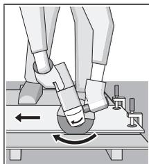
Elektrilise tööriista ettenihke suund peab alati olema vastupidine liikumissuunale. Vastasel korral tekib oht, et tööriist surutakse **kontrollimatult** lõikest välja. Profiilide ja nelikanttorude lõikamist alustage väikseimast ristlõikest.
