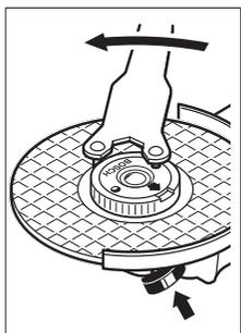
Eine ordnungsgemäß befestigte, unbeschädigte Schnellspannmutter können Sie durch Drehen des Rändelringes entgegen dem Uhrzeigersinn von Hand lösen. **Lösen Sie eine festsitzende Schnellspannmutter nie mit einer Zange, sondern verwenden Sie den Zweilochschlüssel.** Setzen Sie den Zweilochschlüssel wie im Bild gezeigt an.
