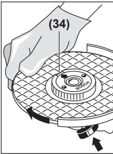
Pritisnite tipku za blokadu vretena (2) kako biste fiksirali brusno vreteno. Za stezanje brzostezne matice okrenite brusnu ploču snažno u smjeru kazaljke na satu.
