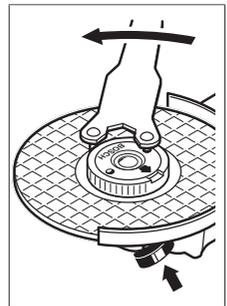
Натиснете бутона за фиксиране на вала (2), за да фиксирате вала за шлифване. За да затегнете бързообтяжната гайка, завъртете диска за шлифване силно по посока на часовника.
