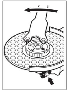
Una tuerca de fijación rápida en buenas condiciones y correctamente fijada, la puede soltar girando el tornillo moleteado con la mano en contra del sentido de giro de las agujas del reloj. **No suelte nunca una tuerca de fijación rápida inmovilizada con unas tenazas, sino utilice la llave de dos pivotes.** Aplique la llave de dos pivotes como se muestra en la imagen.
