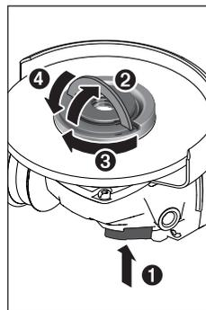
Trykk på spindellåseknappen (2) for å låse slipespindelen. For å stramme hurtigspennmutteren (19) vipper du opp bøylen til hurtigspennmutteren og dreier hurtigspennmutteren hardt med urviseren. Fell deretter ned bøylen som låser hurtigspennmutteren i stillingen. **Det er ikke tilstrekkelig å trekke til på kanten av skiven.**
