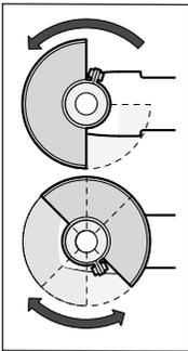
Setzen Sie die Schutzhaube (10) auf den Spindel (4). Passen Sie die Position der Schutzhaube (10) den Erfordernissen des Arbeitsganges an. Arretieren Sie die Schutzhaube (10) durch Festziehen der Feststellschraube (9) mit dem Innensechskantschlüssel (4).
