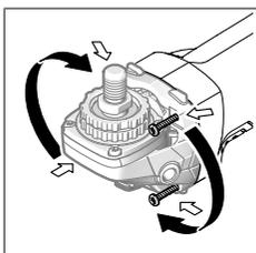
Sie können den Getriebekopf in 90°-Schritten drehen. Dadurch kann der Ein-/Ausschalter für besondere Arbeitsfälle in eine günstigere Handhabungsposition gebracht werden, z. B. für Linkshänder.
