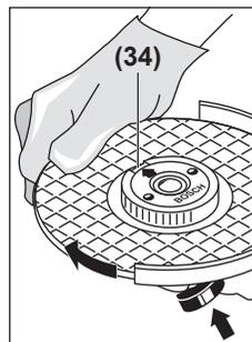
Actionnez le bouton de blocage de broche (2) pour bloquer la broche. Pour serrer l'écrou de serrage rapide, faites tourner d'un geste ferme la meule/le disque dans le sens horaire.
