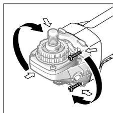
La tête de meuleuse peut être tournée par pas de 90°. Cela permet, lors de certaines applications, d'amener l'interrupteur Marche/Arrêt dans une meilleure position de prise en main, par ex. pour les gauchers. Retirez les 4 vis. Faites pivoter avec précaution la tête de meuleuse dans la nouvelle position **sans la désolidariser du carter**. Resserrez les 4 vis.
