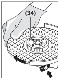
Pritisnite tipko za blokado vretena (2) za blokado brusilnega vretena. Če želite hitrovpenjalno matico zategniti, privijte brusilno ploščo močno v desno.
