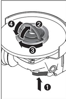
Pentru fixarea arborelui de polizat, apăsați tasta de blocare a arborelui (2). Pentru a strânge piulița cu strângere rapidă (19), basculați în sus clema piuliței cu strângere rapidă și rotiți puternic în sens orar piulița cu strângere rapidă. Apoi basculați în jos clema pentru fixarea piuliței cu strângere rapidă. **Strângerea la marginea discului nu este suficientă.**
