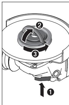
Prawidłowo zamontowaną i nieuszkodzoną szybkozaciskową nakrętkę mocującą (19) można odkręcić ręcznie. W tym celu należy odsunąć pałąk, a następnie energicznym ruchem obrócić szybkozaciskową nakrętkę mocującą w kierunku przeciwnym do ruchu wskazówek zegara. Zbyt mocno dokręconej szybkozaciskowej nakrętki mocującej nie wolno odkręcać za pomocą kombinerek, lecz należy
