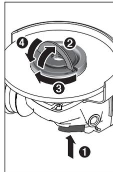
A csiszolótengely rögzítéséhez nyomja meg a (2) tengely reteszelőgombot. A (19) gyorsbefogóanya megszorításához hajtsa fel a gyorsbefogóanya kengyelét és forgassa el a gyorsbefogóanyát erőteljesen az óramutató járásával megegyező irányba. Ezután a gyorsbefogóanya rögzítéséhez hajtsa le a kengyelt. **A tárcsa szélének megszorítása nem kielégítő.**
