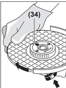
Drücken Sie die Spindel-Arretiertaste (2), um die Schleifspindel festzustellen. Um die Schnellspannmutter festzuziehen, drehen Sie die Schleifscheibe kräftig im Uhrzeigersinn.
