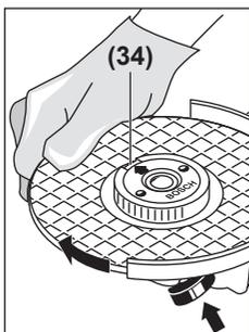
Tryck på spindelåsknappen (2) för att arretera slippindeln. För att dra åt spindelspannmuttern skruvar du slipskivan kraftigt medurs.
