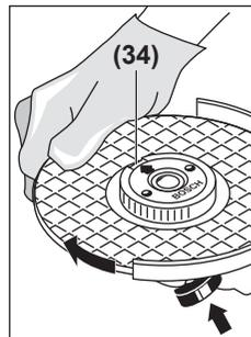
Ажарлау шпинделін (2) бекіту үшін шпиндельді бекіту түймесін басыңыз. Тез қысқыш гайканы бекемдеу үшін ажарлау дискісін күш салып сағат тілінің бағытымен бұраңыз.
