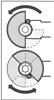
Надіньте захисний кожух (10) на шийку шпинделя. Встановіть захисний кожух (10) в необхідне для виконаної роботи положення. Зафіксуйте захисний кожух (10), затягнувши фіксуючий гвинт (9) ключем-шестигранником (4).
