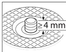
Efter montering av fästet och slip-/kapskivan måste den fria gången på slispindel vara **minst 4 mm**.
