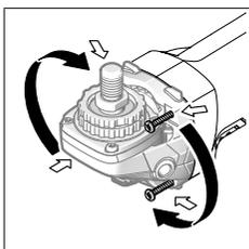
Hlavu převodovky můžete otáčet v krocích po 90°. Tím lze dosáhnout toho, že vypínač bude při zvláštních pracovních situacích v příhodnější poloze pro manipulaci, např. pro leváky.
