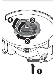
Druk op de asbloekeknop (2) om de slijpas vast te zetten. Om de snelspanmoer (19) vast te draaien, klapt u de beugel van de snelspanmoer omhoog en draait u de snelspanmoer stevig naar rechts. Klap daarna de beugel voor het vastzetten van de snelspanmoer omlaag. **Vastdraaien bij de schijftrand is niet voldoende.**
