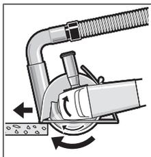
Увімкніть електроінструмент і приставте його передньою частиною напрямних салазок до оброблюваної заготовки. Просувайте електроінструмент із помірною подачею у відповідності до оброблюваного
