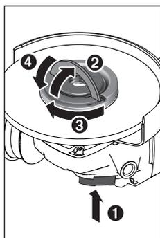
Lihvspindli kinnihoidmiseks vajutage spindli lukustusnuppu (2). Kiirkinnitusmutri (19) pingutamiseks tõstke kiirkinnitusmutri sang üles ja pöörake kiirkinnitusmutrit tugevalt päripäeva. Seejärel suruge sang kiirkinnitusmutri fikseerimiseks alla. **Pingutamine ketta servast pöörates ei ole piisav.**
