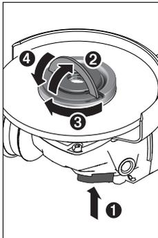
Tryk på spindellåsetasten (2) for at låse slibespindlen. For at spænde lynspændemøtrikken (19) skal du vippe lynspændemøtrikkens bøjle op og dreje lynspændemøtrikken hårdt mod uret. Vip derefter bøjlen ned for at fastgøre lynspændemøtrikken. **Det er ikke tilstrækkeligt at spænde på skivens kant.**
