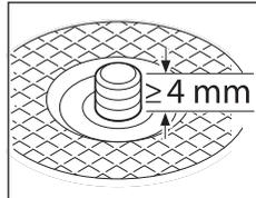
به محکم نشستن ابزار سایش توجه کنید، تا هنگام چرخش روی ابزار برقی از محور جدا نشود.
