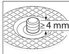
Na de montage van de opnameflens en de (door)slijpschijf moet de vrije schroefdraadlengte van de slijpas **minimaal 4 mm** bedragen.
