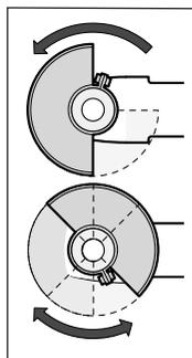
Sett vernedekselet (10) på spindelhalsen. Tilpass plasseringen av vernedekselet (10) etter arbeidsoperasjonen. Lås vernedekselet (10) ved å stramme låseskruen (9) med unbrakonøkkelen (4).
