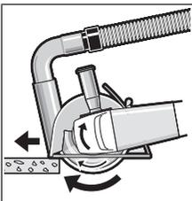
Uključite električni alat i prednjim delom vodećih šina ga stavite na radni komad. Električni alat pomikajte ravnomerno, prilagođeno materijalu koji se obrađuje.
