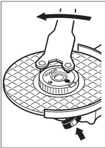
제대로 고정된 손상되지 않은 순간 교환 너트는 너트의 측면에 나있는 홈 부분을 잡고 시계 반대 방향으로 돌려서 손으로 풀 수가 있습니다. **꼭 끼워진 순간 교환 너트는 절대로 플라이어를 사용하지 말고 투핀 스패너를 사용하여 풀어야 합니다.** 투핀 스패너는 도면에 나온 대로 사용하십시오.
