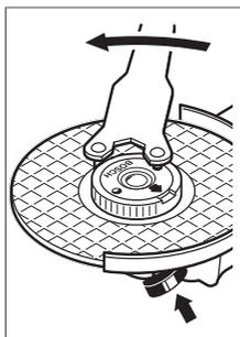
Дұрыс бекітілген, зақымдалмаған тез қысқыш гайканы сақинаны сағат тілінің бағытына қарсы бұрау арқылы шығаруға болады. **Ешқашан қатты бекемделген тез қысқыш гайканы тістеуікпен бұрап алмаңыз, екі бүйірлік тесігі бар гайка кілтін пайдаланыңыз.** Гайка кілтін суретте
