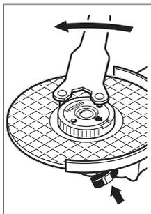
Ένα σωστά στερεωμένο, καλό παξιμάδι ταχυσύσφιξης μπορείτε να το λύσετε με το χέρι, περιστρέφοντας το ρικνωτό δακτύλιο ενάντια στη φορά των δεικτών του ρολογιού. **Μη λύσετε ποτέ ένα μαγκωμένο παξιμάδι ταχυσύσφιξης με μια τσιμπίδα, αλλά χρησιμοποιείτε το γαντζόκλειδο.** Τοποθετήστε το γαντζόκλειδο, όπως φαίνεται στην εικόνα.
