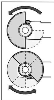
Novietojiet aizsargpārsegu (10) uz darbvārpstas aptveres. Izvēlieties aizsargpārsega stāvokli (10), kas atbilst veicamā darba raksturam. Nostipriniet aizsargpārsegu (10), stingri pieskrūvējot fiksējošo skrūvi (9) ar sešstūra stienpatslēgu (4).
