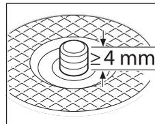
Après montage du flasque de serrage et de la meule / du disque à tronçonner, la longueur de filetage visible doit être **au moins de 4 mm**.
