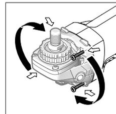
Reduktora galvu var pagriezt 90° iedalījumos. Atsevišķiem darbiem var izvēlēties izdevīgāku ieslēdzēja/izslēdzēja novietojumu, piemēram, ja instrumentu lieto kreilis. Uzskrūvējiet 4 skrūves. Uzmanīgi pagrieziet reduktora galvu vēlamajā
