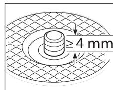
Nach der Montage des Aufnahmeflansches und der Schleif-/Trennscheibe muss die freie Schleifspindelgewindelänge **mindestens 4 mm** betragen.
