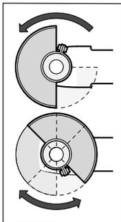
Zet de beschermkap (10) op de ashals. Pas de positie van de beschermkap (10) aan de eisen van de bewerking aan. Vergrendel de beschermkap (10) door de vastzetschroef (9) met de binnenzeskant-sleutel (4) vast te draaien.
