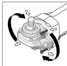
U kunt de machinekop in stappen van  $90^\circ$  draaien. Daardoor kan de aan-/uitschakelaar voor bijzondere toepassingen in een gunstigere bedieningspositie gebracht worden, bijv. voor linkshandigen.
