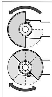
Sæt beskyttelsesskærmen **(10)** på spindelhalzen. Tilpas beskyttelseskappens **(10)** position til arbejdsgangens krav. Fastlås beskyttelseskappen **(10)** ved at spænde indstillingskruen **(9)** med unbrakonøglen **(4)**.
