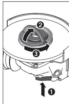
Eine ordnungsgemäß befestigte, unbeschädigte Schnellspannmutter (19) können Sie von Hand lösen. Klappen Sie dazu den Bügel der Schnellspannmutter hoch und drehen Sie die Schnellspannmutter kräftig entgegen dem Uhrzeigersinn. Lösen Sie eine festsitzende Schnellspannmutter nie mit einem Werkzeug, sondern verwenden Sie einen Zweilochschlüssel.
