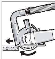
Zapněte elektrické nářadí a nasadte ho přední částí vodicích saní na obrobek. Posuňte elektrické nářadí s mírným posuvem přizpůsobeným obráběnému materiálu. Při dělení mimořádně tvrdých materiálů, např. betonu s vysokým podílem kameniva, se může diamantový dělicí kotouč přehřívat a tím poškodit. Jasně na to ukazuje jiskření po obvodu diamantového dělicího kotouče.
