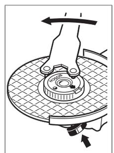
Een correct bevestigde, onbeschadigde snelspanmoer kunt u met de hand losdraaien door de kartelring tegen de klok in (naar links) te draaien. **Draai een vastzittende snelspanmoer nooit met een tang los, maar gebruik de pensleutel.** Zet de pensleutel aan zoals getoond op de afbeelding.
