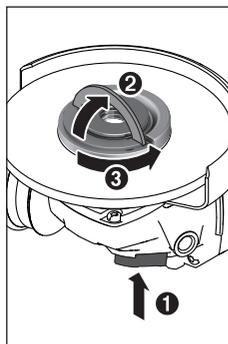
Una tuerca de fijación rápida (19) no dañada y correctamente colocada puede aflojar a mano. Para ello, levante el estribo de la tuerca de fijación rápida y gire vigorosamente la tuerca de fijación rápida en el sentido contrario de las agujas del reloj. No suelte nunca una tuerca de fijación rápida inmovilizada con una herramienta, sino utilice la llave de dos pivotes.
