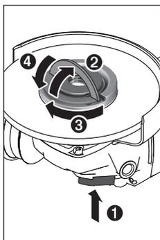
Pritisnite tipku za blokadu vretena (2) kako biste fiksirali brusno vreteno. Za stezanje brzostezne matice (19) otklopite držač brzostezne matice i okrenite brzosteznu maticu snažno u smjeru kazaljke na satu. Zatim preklopite držač za fiksiranje brzostezne matice prema dolje. **Pritezanje na rubu ploče nije dovoljno.**
