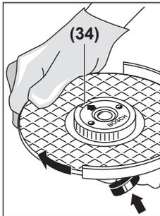
Per bloccare il mandrino portamola, premere il pulsante di bloccaggio dell'alberino (2). Per fissare il dado autoserrante, ruotare con forza la mola abrasiva in senso orario.
