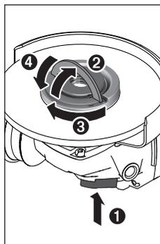
Nacisnąć przycisk blokady wrzeciona (2), aby unieruchomić wrzeciono szlifierki. Aby dokręcić szybkozaciskową nakrętkę mocującą (19), należy odsunąć pałąk, a następnie energicznym ruchem obrócić szybkozaciskową nakrętkę mocującą w kierunku zgodnym z ruchem wskazówek zegara. Przesunąć pałąk na dół w celu zablokowania szybkozaciskowej nakrętki mocującej. **Nie wystarczy dokręcić na-**
