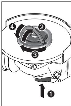
Per bloccare il mandrino portamola, premere il pulsante di bloccaggio dell'alberino (2). Per fissare il autoserrante (19), sollevare la staffa del dado stesso e ruotare con forza quest'ultimo in senso orario. Riabbassare quindi la staffa, per fissare il dado autoserrante. **Serrare sul solo bordo della mola non sarà sufficiente.**
