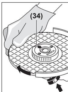
Lihvspindli paigaldamiseks vajutate spindli lukustusnuppu (2). Kiirkinnitusmutri pingutamiseks keerake lihvketast tugevalt päripäeva.
