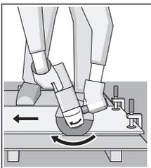
Електроинструментът трябва да се води винаги подаване в обратна посока. В противен случай съществува опасност той да бъде изхвърлен неконтролируемо от среза. При рязане на профили и четириъгълни тръби най-добре използвайте минималното напречно сечение.
