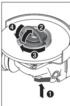
Tryck på spindellåsknappen (2) för att arretera slispindel. För att dra åt snabbspänningsmuttern (19), dra bygeln på snabbspänningsmuttern kraftigt medsols. Fäll ner bygeln igen för att fixera snabbspänningsmuttern. **Att dra åt i kanten är inte tillräckligt.**
