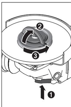
Du kan løse en uskadet hurtigspennmutter (19) som er riktig festet, for hånd. Da feller du opp bøylen til hurtigspennmutteren og dreier hurtigspennmutteren hardt mot urviseren. En hurtigspennmutter som sitter fast, må aldri løses med et verktøy. Bruk en tohullsnøkkel.
