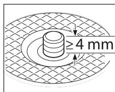
Po zamontowaniu kołnierza i tarczy szlifierskiej/tnącej widoczna długość gwintu wrzeciona szlifierki powinna wynosić **minimum 4 mm**.
