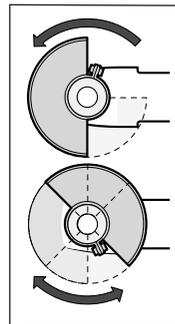
Așază capacul de protecție (10) pe gulerul axului. Adaptează poziția capacului de protecție (10) în funcție de procesul de lucru. Blochează capacul de protecție (10) strângând șurubul de fixare (9) cu ajutorul cheii hexagonale (4).
