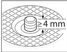
Po montáži upínací příruby a brusného/dělicího kotouče musí činit volná délka závitů brusného vřetena **minimálně 4 mm**. Dbejte na řádné upevnění brusného nástroje, aby se při dělení elektronářadí
