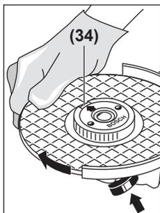
Pressione a tecla de bloqueio do veio (2), para bloquear o veio de retificação. Para apertar a porca de aperto rápido, rode o disco abrasivo para a direita com força.
