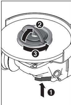
Puteți desface manual o piuliță cu strângere rapidă care este nedeteriorată și fixată corect (19). Pentru aceasta, basculați în sus piulița cu strângere rapidă și rotiți-o puternic în sens antiorar. Nu slăbiți niciodată cu o sculă o piuliță cu strângere rapidă care este blocată, ci folosiți o cheie pentru șplinturi în acest scop.
