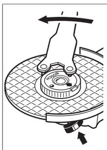
En korrekt fäst och oskadad snabbspanningsmutter kan du lossa genom att vrida den räfflade ringen moturs för hand. **Lossa aldrig en åtdragen snabbspanningsmutter med en tång, utan används kombinyckeln.** Sätt an kombinyckeln på det sätt som visas på bilden.
