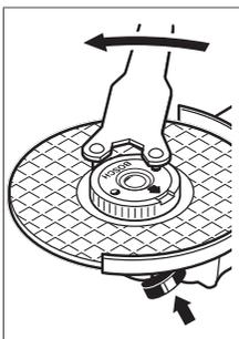
Oikein kiinnitetty ja ehjä pikakiinnitysmutteri on mahdollista avata käsin. Avaa mutteri kiertämällä pyällettyä rengasta vastapäivään. **Älä missään tapauksessa avaa kiinni juuttunutta pikakiinnitysmutteria pihdeillä, vaan käytä laikka-avainta.** Aseta laikka-avain kiinnityskohtaan kuvan mukaisesti.
