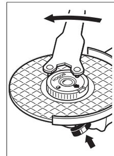
پس از مونتاژ ابزار سایش و قبل از روشن کردن ابزار برقی کنترل کنید که این ابزار بطور صحیح مونتاژ شده باشد و بطور آزاد قابل چرخش باشد. اطمینان حاصل کنید که ابزار ساینده و متعلقات با حفاظ ایمنی و یا با قطعات دیگر تماس نداشته باشد.
