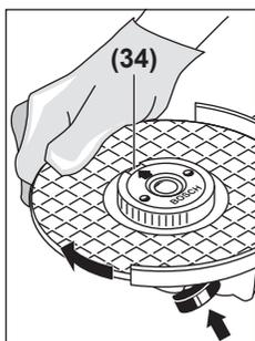
A csiszolótengely rögzítéséhez nyomja meg a (2) tengely reteszelő gombot. A gyorsbefogó anya megszorításához forgassa el erőteljesen a csiszolókorongot az óramutató járásával megegyező irányba.
