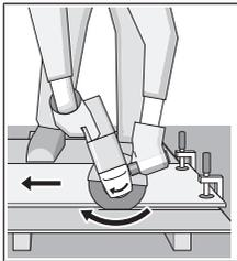
Elektronarzędzie należy zawsze prowadzić przeciwbieżnie do kierunku obrotów tarczy. W przeciwnym razie istnieje niebezpieczeństwo, że zostanie ono w sposób niekontrolowany wypchnięte ze szczeliny. W przypadku cięcia profili i rur czworokątnych, zaleca się zacząć pracę od najmniej-
