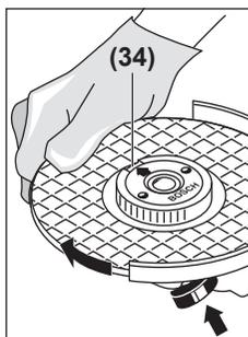
Для фиксирования шлифовального шпинделя нажмите кнопку фиксирования шпинделя (2). Чтобы затянуть быстрозажимную гайку, поверните шлифовальный круг с усилием по часовой стрелке.
