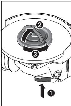
En korrekt fastgjort, ubeskadiget lynspændemøtrik (19) kan løsnes manuelt. Vip lynspændemøtrikkens bøjle op, og drej lynspændemøtrikken hårdt mod uret. Brug aldrig et værktøj til at løsne en fastsiddende lynspændemøtrik, men anvendt i stedet spændenøglen.
