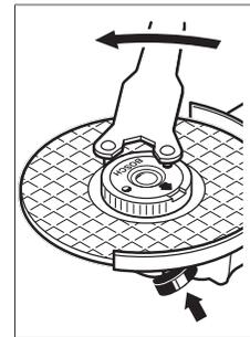
Закріплену належним чином, непошкоджену швидкозатискну гайку можна відпустити, вручну повертаючи кільце з накаткою проти стрілки годинника. **Ніколи не відкручуйте швидкозатискну гайку, яка сидить дуже міцно, кінцями – використовуйте ріжковий ключ під два отвори.** Приставляйте
