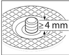
Po montáži upínacej príruby a brúsneho/rezacieho kotúča musí byť dĺžka závitú brúsneho vretena **minimálne 4 mm**.
