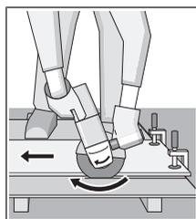
Elverktyget måste alltid föras med motrotation. Annars föreligger risk för att den trycks ut ur kapningen **okontrollerat**. Vid kapning av profiler och fyrkantströr är det bäst att sätta an där diametern är som minst.
