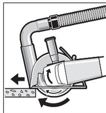
Elektrinį įrankį įjunkite ir kreipiamųjų pavažų priekine dalimi pridėkite prie ruošinio. Stumkite elektrinį įrankį pagal apdorojamą paviršių pritaikytą pastūmą.
