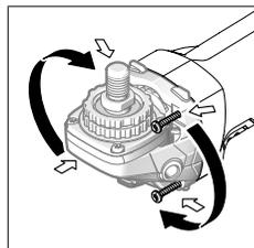
Vaihteiston päätä voi kääntää 90 astetta kerrallaan. Näin käyttökytkimen voi sijoittaa parempaan asentoon erilaisia käyttötilanteita varten, esim. jos koneen käyttäjä on vasenkätinen. Kierrä 4 ruuvia kokonaan irti. Käännä vaihteiston pää varovasti **ja kotelosta irrottamatta** uuteen asentoon. Kiristä 4 ruuvia.
