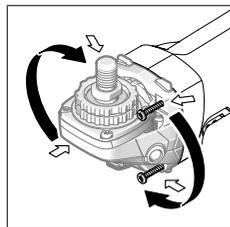
A hajtóműfejet 90°-os lépésekben el lehet forgatni. Így a be-/kikapcsolót különleges munkavégzési esetekhez, például balkezes kezelők számára, egy előnyösebb helyzetbe lehet hozni. Teljesen csavarja ki a 4 csavart. Óvatosan, **és anélkül, hogy levenné a házról, for-**
