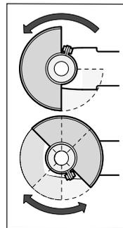
Placez le capot de protection (10) sur le collet de broche. Adaptez la position du capot de protection (10) aux exigences du travail à effectuer. Bloquez le capot de protection (10) en serrant la vis de blocage (9) au moyen de la clé mâle pour vis à six pans (4).
