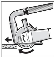
Включите электроинструмент и приставьте переднюю часть направляющих салазок к обрабатываемой заготовке. Ведите электрический инструмент с равномерной, рассчитанной на обрабатываемый материал подачи.
