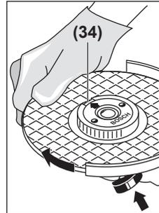
Stiskněte aretační tlačítko vřetena (2), abyste brusné vřeteno zablokovali. Pro utažení rychloupínací matice otáčejte silou brusným kotoučem po směru hodinových ručiček.
