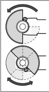
Należy użyć pokrywy ochronnej (10) na szyjkę wrzeciona. Pozytywna pokrywa ochronnej (10) powinna być dopasowana do rodzaju obróbki. Zablokować pokrywę ochronną (10), dokręcając śrubę ustalającą (9) za pomocą klucza sześciokątnego (4).
