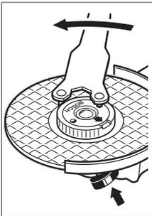
Pravilno pričvršćenu, neoštećenu brzosteznu maticu možete ručno otpustiti okretanjem nazubljenog prstena u smjeru suprotnom od kazaljke na satu.
