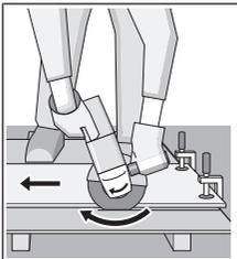
Das Elektrowerkzeug muss stets im Gegenlauf geführt werden. Es besteht sonst die Gefahr, dass es **unkontrolliert** aus dem Schnitt gedrückt wird. Beim Trennen von Profilen und Vierkantrohren setzen Sie am besten am kleinsten Querschnitt an.
