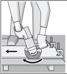
Griešanas laikā elektroinstrumentu vienmēr jāpārvieto atpakaļvirzienā. Pretējā gadījumā pastāv iespēja, ka griešanas disks tiks **nekontrolēti** mest ārā no griezuma. Griežot profilus un četrstūra caurules, ieteicams uzsākt griešanu vietā ar vismazāko šķērsriezuma laukumu.
