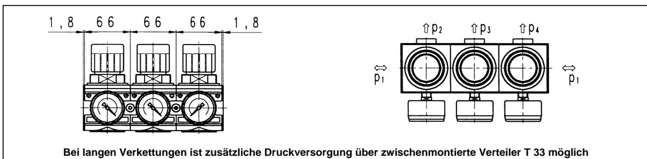
Bei langen Verkettungen ist zusätzliche Druckversorgung über zwischenmontierte Verteiler T 33 möglich
