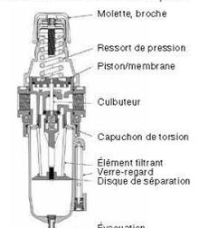
Après la mise en service, une inspection et une maintenance doivent être réalisées régulièrement. En cas d'apparition de condensation, purger régulièrement à brefs intervalles l'eau de condensation au niveau de la vis de purge de condensation. Les intervalles de maintenance dépendent du mode opératoire du filtre-régulateur de pression, mais doivent être réalisés au moins tous les 6 mois.
