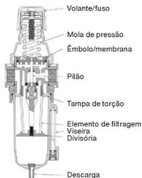
Após a colocação em funcionamento, é necessário realizar regularmente uma inspeção/manutenção. Caso seja formada condensação, purgá-la frequentemente com o parafuso de purga de condensação. Os intervalos de manutenção dependem do modo de funcionamento do regulador de pressão do filtro mas não devem exceder períodos de 6 meses, no máximo.
