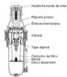
Después de la puesta en servicio, se debe realizar periódicamente su inspección y mantenimiento. Si se genera condensación, descargar regularmente la condensación a través del tornillo de purga de condensado. Los intervalos de mantenimiento dependen del modo de funcionamiento del regulador del filtro; sin embargo, se deben realizar cada 6 meses como máximo.
