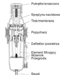
Po uruchomieniu należy regularnie przeprowadzać kontrole i konserwację. Jeśli grodzi się kondensat, należy regularnie w krótkich odstępach czasu spuszczać kondensat poprzez śrubę spustową kondensatu. Okresy konserwacyjne są uzależnione od rodzaju eksploatacji regulatora filtra, jednakże powinny być przeprowadzane najpóźniej co 6 miesięcy.
