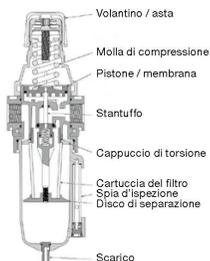
In seguito alla messa in funzione, effettuare regolarmente ispezione e manutenzione. In caso di formazione di condensa, scaricare regolarmente a intervalli ridotti la condensa tramite l'apposita vite di scarico. Gli intervalli di manutenzione dipendono dal modo di utilizzo del regolatore di pressione con filtro, ma gli interventi devono essere eseguiti ai più tardi ogni 6 mesi.
