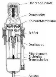
Nach der Inbetriebnahme muss regelmäßig eine Inspektion und Wartung durchgeführt werden. Bei Anfall von Kondensat regelmäßig in kurzen Abständen an der Kondensatablassschraube das Kondensat ablassen. Die Wartungsintervalle sind abhängig von der Betriebsart des Filterdruckreglers, sollten aber spätestens alle 6 Monate erfolgen.
