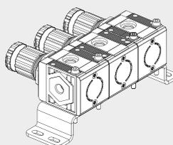
**Befestigung an Schiene nach DIN EN50022 mit 2 Stück Adaptoren**
