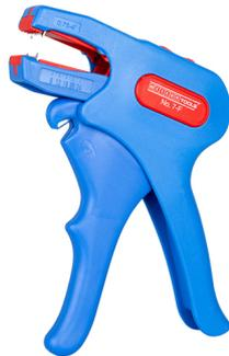
Die WEICON Abisolierzange No. 7-F eignet sich besonders gut für 2- oder 3-adrige PVC-isolierte Flachkabel von 0,75 – 4,0 mm<sup>2</sup>. Das Werkzeug verfügt über eine mehrfach verstellbare Feineinstellung. Die Zange verfügt über ein optisches Längenmaß von 8 - 24mm, Ein gut zugänglicher Seitenschneider ist in das Werkzeug integriert, der bis zu einem Kabeldurchmesser von 3 mm genutzt werden kann und die Klingen sind wechselbar.
