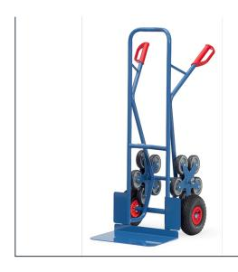
Stabile Schweißkonstruktion, mit Stahlblechschaufel, pulverbeschichtet, nur blau RAL 5007. Sicherheitsgriffe. Zerlegte Anlieferung. Mit 2 Lufträdern, Kunststoff-Felgen, Naben mit Rollenlagerung und 2 fünfarmigen Rad-Sternen, jeweils 5 TPE-Räder 125 mm Ø, Naben mit Gleitlager. Bügel oben und Querstreben durchgebogen. Für den sicheren Transport von runden Gütern, wie Rollen, Kannen, Eimern usw.
