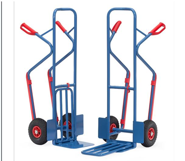
Handlich, mit großer Stahlrohr-Klappschaufel. Stabile Schweißkonstruktion, pulverbeschichtet, blau RAL 5007. Sicherheitsgriffe. Räder mit Luftbereifung auf Kunststoff-Felgen. Naben mit Rollenlager. Bügel oben und Querstreben durchgebogen. Für den sicheren Transport von runden Gütern, wie Rollen, Kannen, Eimern usw. Zerlegte Anlieferung.
