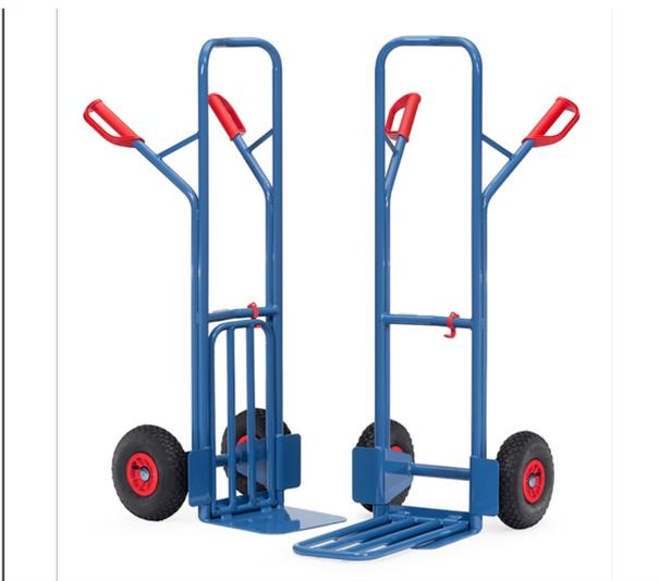
Handlich, mit großer Stahlrohr-Klappschaufel. Stabile Schweißkonstruktion, pulverbeschichtet, blau RAL 5007. Sicherheitsgriffe. Räder mit Luftbereifung auf Kunststoff-Felgen. Naben mit Rollenlager. Bügel oben und Querstreben durchgebogen. Für den sicheren Transport von runden Gütern, wie Rollen, Kannen, Eimern usw. Zerlegte Anlieferung.
