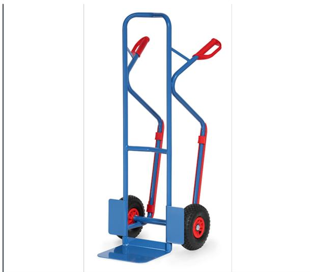
Stahlrohr-Stapelkarre mit Stahlblechschaufel, stabile Schweißkonstruktion, pulverbeschichtet blau RAL 5007. fetra Sicherheitsgriffe. Stahlblechschaufel anschraubbar und dadurch austauschbar. Mit auswechselbaren Kunststoff-Gleitkufen. Räder mit Luftbereifung, auf Kunststoff-Felgen, Naben mit Rollenlagerung. Bügel oben und Querstreben durchgebogen. Für den sicheren Transport von runden Gütern, wie Rollen, Kannen, Eimern usw. Zerlegte Anlieferung.
