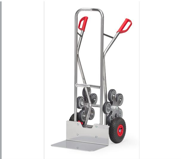
Aus Aluminiumrohr mit Aluminiumschaufel, handliche Schweißkonstruktion. Sicherheitsgriffe. Mit 2 Lufträdern, Kunststoff-Felgen, Naben mit Rollenlagerung und 2 fünfarmigen Radsternen, jeweils 5 TPE-Räder 125 mm Ø, Naben mit Gleitlager. Bügel oben und Querstreben durchgebogen. Für den sicheren Transport von runden Gütern, wie Rollen, Kannen, Eimern usw.
