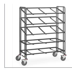
Eurokastenwagen in elektrisch leitfähiger Ausführung (ESD = Electrostatic Discharge). Stahlrohr und Profilstahl geschweißt, elektrisch leitfähig pulverbeschichtet in schiefergrau RAL 7015. Schraubkonstruktion. 5
