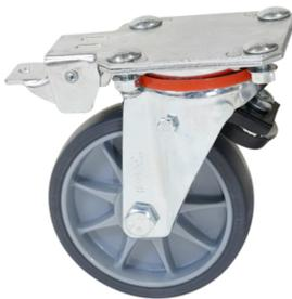
Als Ersatz für eine Rolle an der das TOTALSTOP-Zentralbremssystem befestigt ist. Gehäuse Stahlblech verzinkt. Räder mit TPE-Bereifung (thermoplastisches Elastomer). Kunststoff-Felgen, Naben mit Rillenkugellager und Fadenschutz. Sehr geringer Anfahr-, Roll- und Schwenkwiderstand. Reifen nicht kreidend (spurlos).
