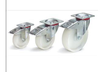
Mit Feststeller Doppelstopp. Räder aus Polyamid, Naben mit Rollenlager. Weitgehend beständig gegen Salzwasser, Laugen und Säuren. Temperaturbeständig von -40° bis +90° C.
