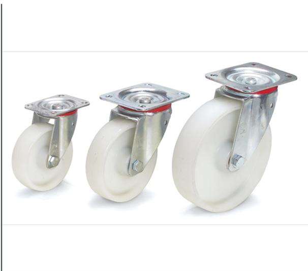
Gehäuse Stahlblech verzinkt. Räder aus Polyamid, Naben mit Rollenlager. Weitgehend beständig gegen Salzwasser, Laugen und Säuren. Temperaturbeständig von  $-40^{\circ}$  bis  $+90^{\circ}$  C.
