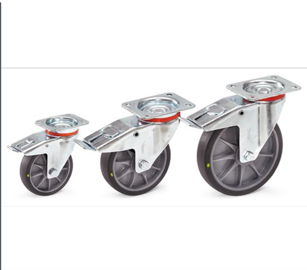
Gehäuse Stahlblech verzinkt. Räder mit TPE-ESD-Bereifung (thermoplastisches Elastomer elektrisch leitfähig). Naben mit Präzisions-Rillenkugellager. Reifen nicht kreidend (spurlos).
