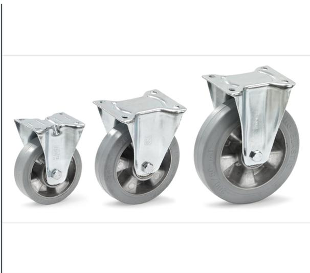
Gehäuse Stahlblech verzinkt. Räder mit Elastic-Bereifung, Reifen blaugrau, nicht kreidend (spurlos). Alu-Felgen, Naben mit Kugel lager. Leichter, elastischer Lauf, hohe Lebensdauer.
