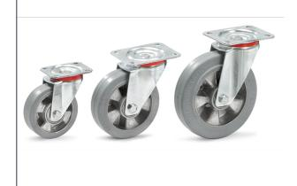
Gehäuse Stahlblech verzinkt. Räder mit Elastic-Bereifung, Reifen blaugrau, nicht kreidend (spurlos). Alu-Felgen, Naben mit Kugel lager. Leichter, elastischer Lauf, hohe Lebensdauer.
