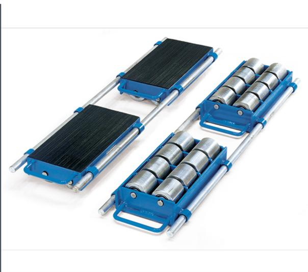
Für den leichten und sicheren Transport von Maschinen und anderen schweren Gegenständen. Stabile Stahl-Schweißkonstruktion, mit Handgriffen aus Rundstahl, pulverbeschichtet blau RAL 5007. Tragplatten mit rutschhemmender Gummiauflage versehen. Große Stahlrollen kugelgelagert. Verstellbereich: 850-1190 mm.
