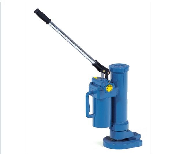
Maschinenheber zum Heben mit Hubklaue und Kopfplatte und durch eingebaute Hand-Hydraulikpumpe mit wenig Kraftaufwand möglich. Feinfühliges Senken über Senkventil, Überlastventil. Pumphebel abnehmbar. Das Gehäuse ist um 360° drehbar, in jeder Lage einsetzbar. Stabile Stahl-Kompakt-Konstruktion, Beschichtung blau RAL 5007. Hubbereich an Hubklaue 6932: 30-260 mm; Hubbereich an Kopfplatte 6932: 420-650 mm.
