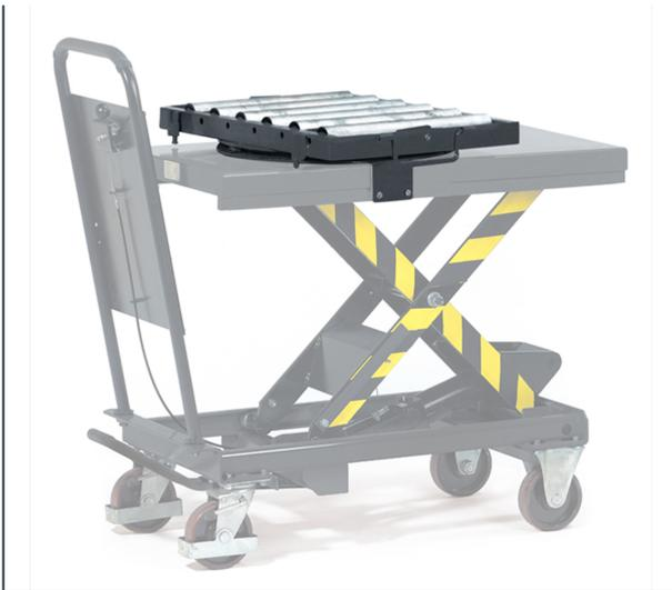
Durch Klemmverschraubung auf Plattform zu befestigen, schwenkbar um 360°, arretierbar. 6 kugelgelagerte Stahlrollen 57 mm Ø und 430 mm Länge. Achsabstand: 110 mm. Höhe: 92 mm. Schwenkbar. Passend für die Hubtischwagen 6833-6837.
