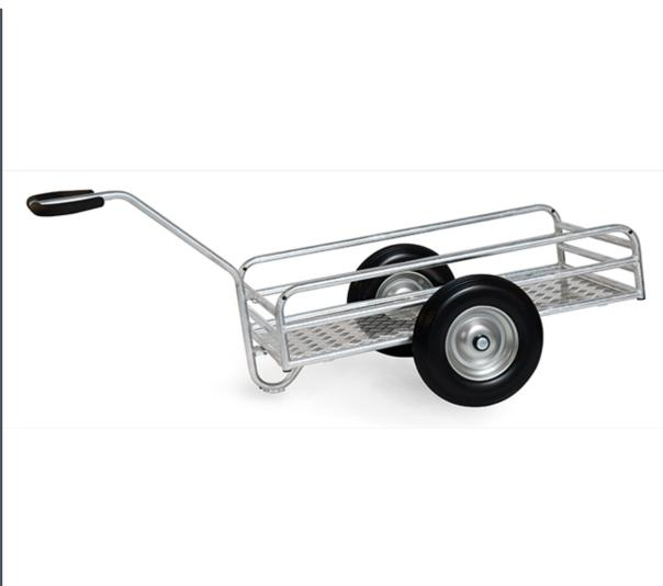
Handwagen für die Verwendung im Außenbereich. Aus Stahlrohr geschweißt, feuerverzinkt. Ladefläche aus Alu-Quintettblech. Geländer 180/250 mm hoch mit kräftigen Rohrverstreben. Anschraubbare Deichsel mit Sicherheitsgriff und hautsympathischem Softgrip-Bezug. Große Räder mit verzinkter Stahlblechfelge, mit pannensicherer Polyurethanbereifung, Naben mit Rollenlager. Verschraubte Radbefestigung für einfachen Radwechsel.
