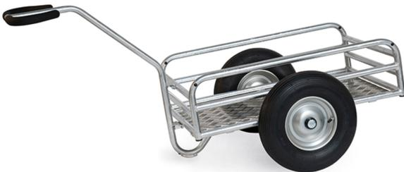
Handwagen für die Verwendung im Außenbereich. Aus Stahlrohr geschweißt, feuerverzinkt. Ladefläche aus Alu-Quintettblech. Geländer 180/250 mm hoch mit kräftigen Rohrverstreben. Anschraubbare Deichsel mit Sicherheitsgriff und hautsympathischem Softgrip-Bezug. Große Räder mit verzinkter Stahlblechfelge, mit Luftbereifung, Naben mit Rollenlager. Verschraubte Radbefestigung für einfachen Radwechsel.
