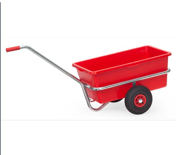
Leichter und sehr handlicher Handwagen. Aus Stahlrohr geschweißt, feuerverzinkt. Für die Verwendung im Außenbereich geeignet. Deichsel anschraubbar. Mit herausnehmbarer Kunststoffmulde. Mulde 90 Liter Inhalt, L x B x H = 715 x 420 x 320 mm. Räder mit Luftbereifung. Naben mit Rollenlager. Zerlegte Anlieferung, leichte Selbstmontage.
