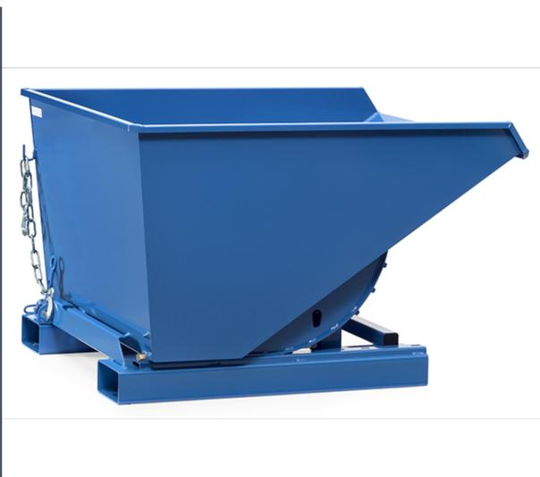
Selbstkipper müssen zum Entleeren nicht angehoben werden. Die leere Mulde geht selbsttätig in die Beladestellung zurück. Robuste Schweißkonstruktion aus 3-mm-Stahlblech, Lackierung blau RAL 5007. Serienmäßig mit Stapertaschen, Abrollsicherung und Kippverriegelung, Gliederkette als Abrutsch- und Kippsicherung. Zugseil zur Kippauslösung vom Staplersitz aus.
