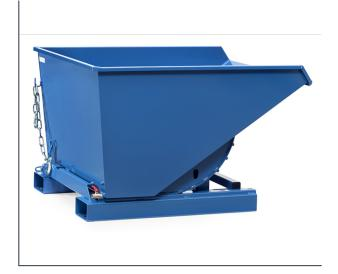
Selbstkipper müssen zum Entleeren nicht angehoben werden. Die leere Mulde geht selbsttätig in die Beladestellung zurück. Robuste Schweißkonstruktion aus 3-mm-Stahlblech, Lackierung blau RAL 5007. Serienmäßig mit Staplertaschen, Abrollsicherung und Kippverriegelung, Gliederkette als Abrutsch- und Kippsicherung. Zugseil zur Kippauslösung vom Staplersitz aus. Zusatz "A" bedeutet mit Ablasshahn und Sieb zum Trennen von Flüssigkeiten und Feststoffen.
