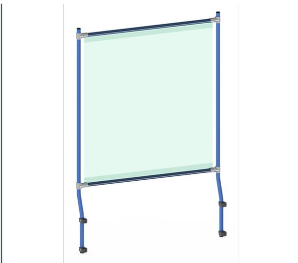
Infektionsschutzrahmen als Anbausatz für viele fetra-Transportgeräte. Rahmenkonstruktion Stahlrohr verschraubt, pulverbeschichtet blau RAL 5007. Transparente PVC-Folie als Barriere gegen Tröpfcheninfektionen, z.B. mit dem Coronavirus. Einfache Selbstmontage mittels Kunststoffschellen, auch nachrüstbar. Höhe justierbar, um z.B. eine Durchreiche zu erzeugen.
