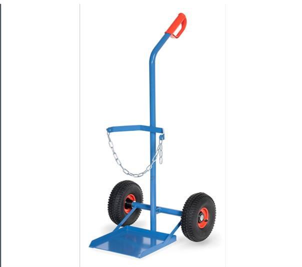
Stahlflaschenkarre aus Stahlrohr geschweißt, pulverbeschichtet blau RAL 5007. Flaschenhalterungen mit Kettensicherung. Räder mit Luftbereifung, Naben mit Rollenlager. Für 1 Propangasflasche 33 kg Inhalt, Ø 318 mm.
