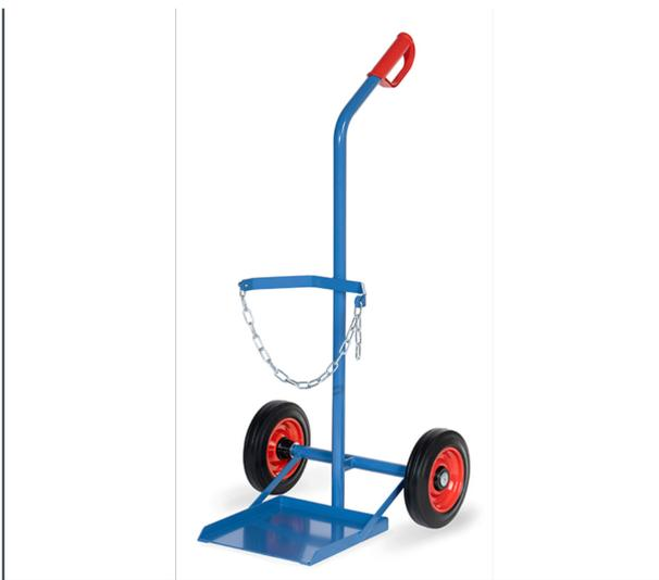
Stahlflaschenkarre aus Stahlrohr geschweißt, pulverbeschichtet blau RAL 5007. Flaschenhalterungen mit Kettensicherung. Räder mit Vollgummibereifung, Naben mit Rollenlager. Für 1 Propangasflasche 33 kg Inhalt, Ø 318 mm.
